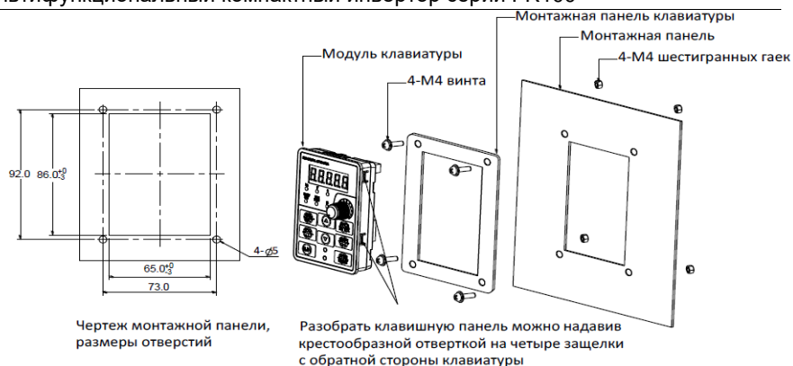
Рис. 2-5 Размерная схема установки внешней клавиатуры
